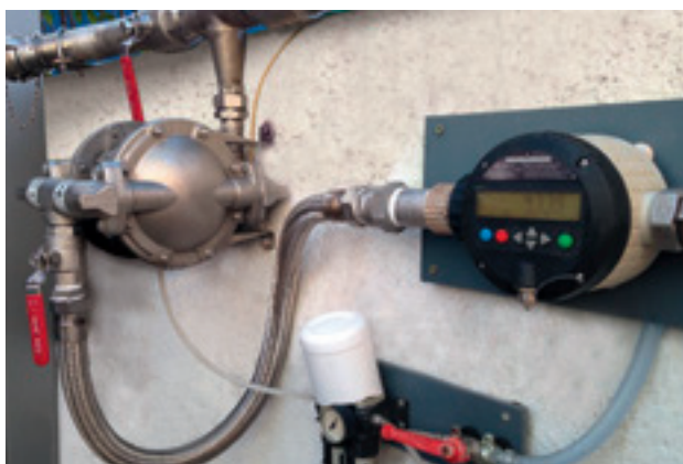
FMC 100 in Kombination mit Druckluft-Membranpumpe (hier: Fremdfabrikat) für manuellen Einsatz.
